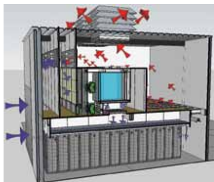
Principeschema werking van de klimatisering bij ColoCenter Zoetermeer.
