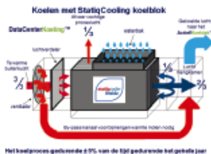
Afkoelingsprincipe van de lucht met het koelblok of luchtwarmtewisselaar van StatigCooling.
